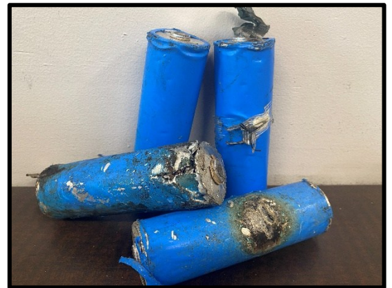
Cellules au lithium d'environ 4 cm de diamètre par 13 cm de longueur à l'origine du début d'incendie
